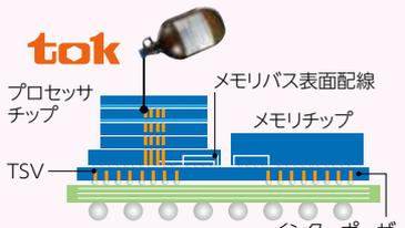
半導体チップを個々に切り出して、各種パッケージに封入する工程。フォトレジストの厚膜形成能力等を活かします。
