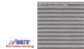
低分子フォトレジストを用いEUV露光により得られた28nmパターン (露光装置:HINA) (NEDO委託研究としてASET EUVプロセス技術研究室にて評価しました)
