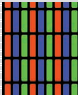
▲カラーフィルター概略図 R(赤)、G(緑)、B(青)の間に存在するのがブラックマトリクス
